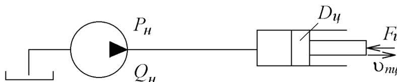
Рис. 7.8. – Схема гидропривода к задаче 7.11
